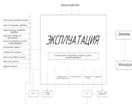
Рис. 2 - Факторы, влияющие на надежность элегазового оборудования в процессе эксплуатации
