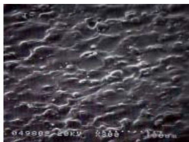
Рис. 1 - Поверхность импланта РЕЕК под микроскопом
