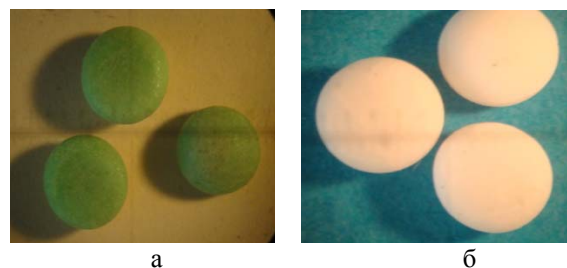
Рис. 3 – Микрофотографии гранулированного НА: а) с добавкой оксида никеля; б) с добавкой оксида цинка
