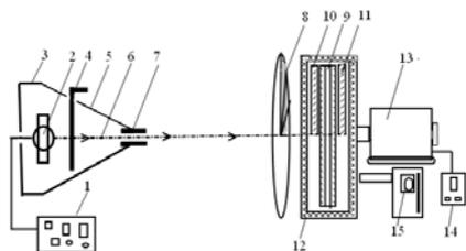
**Рис 1 – Схема установки для исследования эффективности действия усиливающих экранов на эмульсионные слои с различными средними размерами микрокристаллов AgHal в зависимости от энергии ионизирующего излучения**
