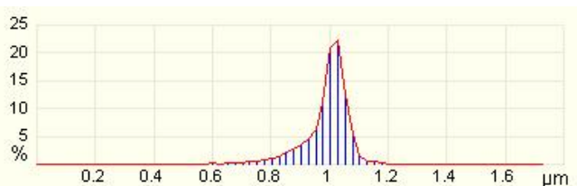
Рис. 3 - Порошок на срезе плазматрона без соединения плазматрона к реактору
