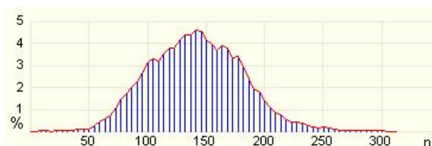
Рис. 8 - Порошок с пластин электростатического фильтра
