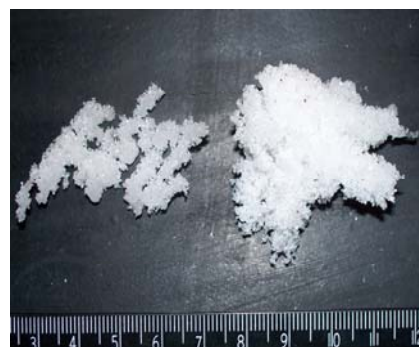
Рис. 2 - Результат сфероидизации в плазме порошка двуокиси кремния
