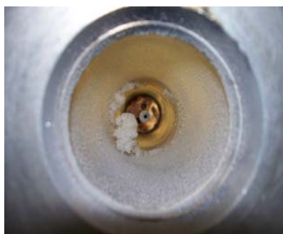
Рис. 1 - Разрядная камера ВЧИ плазмотрона с осажденным порошком
