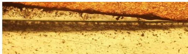
Рис. 3 – Разрушение сварного соединения по границе вторичной фазы с медной трубой (x70)
