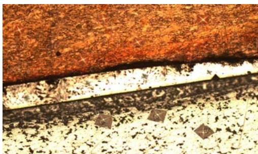
**Рис. 4 - Измерение микротвёрдости по периметру вздутий алюминиевой трубы (x75)**
