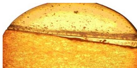
Рис. 2 – Эвтектический композиционный сплав полученный сваркой Al-Cu
