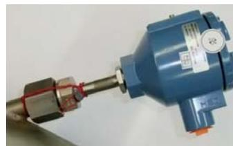
**Рис. 4 - Преобразователь температуры Pt – 100**
