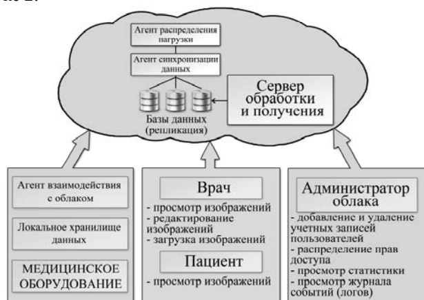
Рис. 2 - Структурная схема облачной системы обработки и хранения цифровых данных, полученных на медицинском оборудовании
