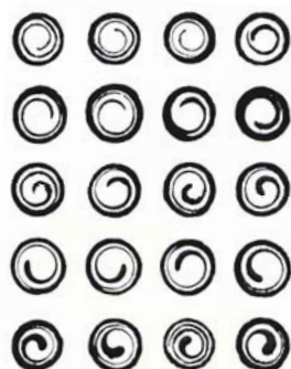
Рис. 4 - Характер распределения черного и белого полиэтилена марки ПВД в поперечном срезе извитого комбинированного экструдата
