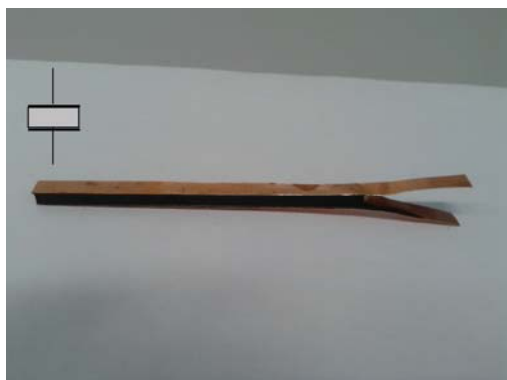
Рис. 2 - Фотография и схематическое обозначение образца варианта кабеля с саморегулирующейся токопроводящей композицией между двумя полосками медной фольги
