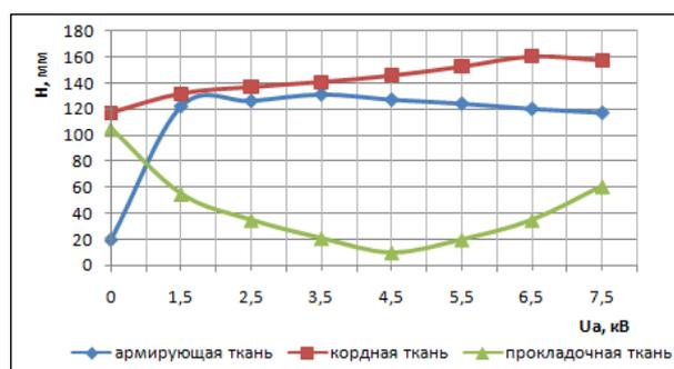
Рис. 1 - Зависимость капиллярности каркасных тканей от напряжения на аноде ( $G=0,04$  г/с,  $P=26,6$  Па,  $I_a=0,5$  А,  $\tau=180$  с, для армирующих и кордных тканей: плазмообразующий газ – аргон, для прокладочных – аргон-пропан-бутан 70/30)
