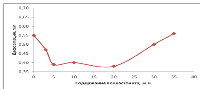
Рис. 2- Зависимость абсолютной остаточной деформации линолеума от содержания волластонита в рецептуре линолеума, полученного в лабораторных условиях
