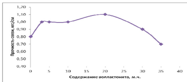
Рис. 1 - Зависимость прочности связи между слоями линолеума от содержания волластонита в рецептуре ПВХ-пластизола
