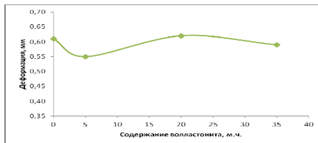
Рис. 3- Зависимость абсолютной остаточной деформации линолеума от содержания волластонита в рецептуре линолеума, полученного на промышленной линии
