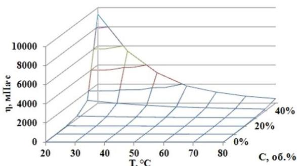
**Рис. 3 – зависимость коэффициента вязкости композиционного материала «нитрид алюминия – кремнийорганический лак КО-916К» от температуры и содержания наполнителя**
