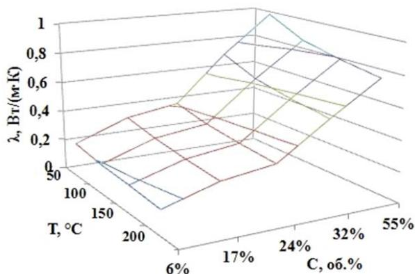
**Рис. 1** – зависимость коэффициента теплопроводности композиционного материала «нитрид алюминия – кремнийорганический лак КО-916К» от температуры и содержания наполнителя
