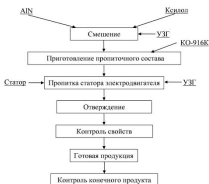
**Рис. 5 – Технологическая схема пропитки асинхронного электродвигателя пропиточным составом из кремнийорганического лака КО-916К наполненного нитридом алюминия**
