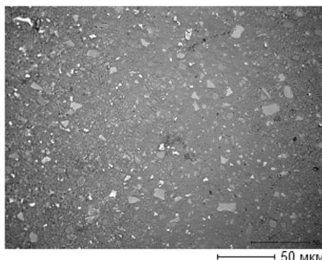
**Рис. 2** – Фотография отвержденного композиционного материала «AlN – кремнийорганический лак КО-916К»
