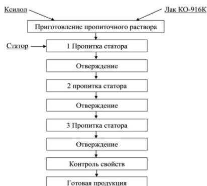
**Рис. 4 – Технологическая схема пропитки обмотки статора асинхронного электродвигателя, применяемая на ЗАО Уралэлектромаш, г. Каменск-Уральский**
