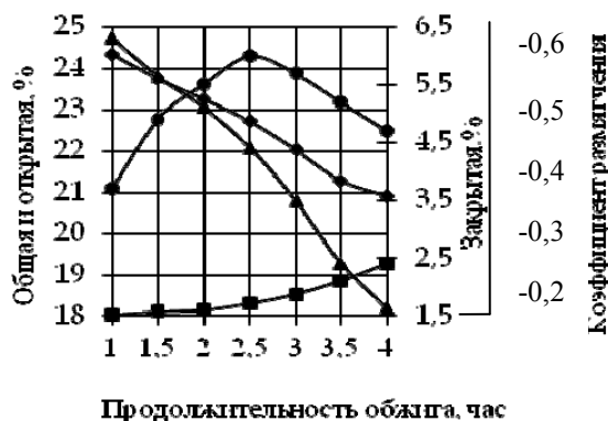
Рис. 3 – Влияние продолжительности обжига на общую, открытую, закрытую пористость и коэффициент размягчения
