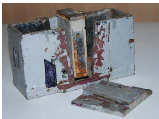
Рис. 1 – Прибор конструкции В.Ф.Ермакова для определения сопротивления срезу по поверхности смерзания с материалом фундамента (бетон, сталь, покрытия)
