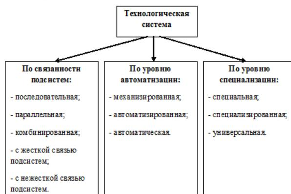
**Рис. 1 - Виды технологических систем**
