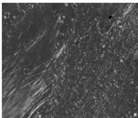
Рис. 1 - Текстура, характерная для системы C_{12}EO_4/La/H_2O 75/25 %масс ( \times 100 )
