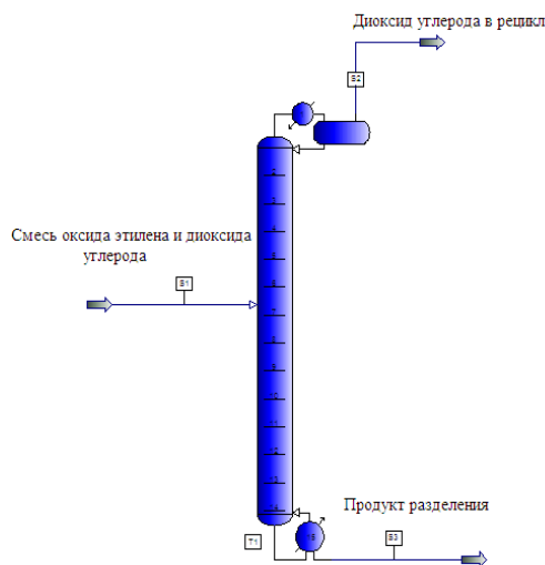
Рис. 1 - Схема потоков дистилляционной колонны
