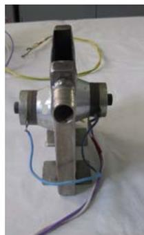
**Рис. 1 – Ультразвуковая установка с частотой озвучивания 24 кГц**
