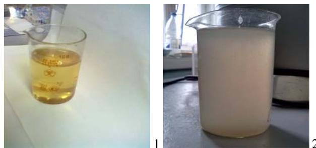
Рис. 4 – Образование осадка в пробах при ультразвуковой обработке: 1 - до ультразвуковой обработки; 2 - после ультразвуковой обработки
