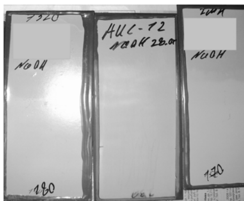
Рис. 1 – Результаты выдержки образцов в 10 %-ом растворе NaOH. Слева направо: Epicur TH7320, АИС-12, Этал 2МК
