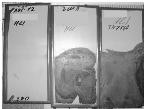
Рис. 2 – Результаты выдержки образцов в 10 %-ом растворе HCl. Слева направо: АИС-12, Этал 2МК, Epicur TH7320
