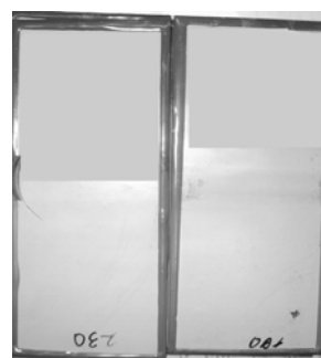
Рис. 3 – Результаты выдержки образцов в 10 %-ом растворе H 2 SO 4 . Слева направо: АИС-12, Этал 2МК
