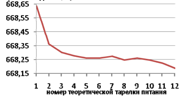
Рис.1. Зависимость массового расхода ЭНБ в кубовой жидкости К-1 от номера теоретической тарелки питания
