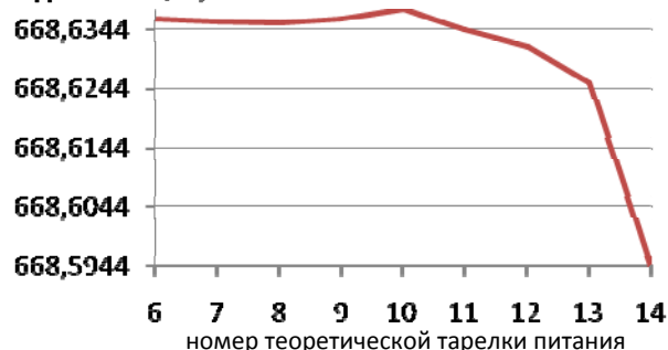
Рис.3. Зависимость массового расхода ЭНБ в дистилляте К-2 от номера теоретической тарелки питания
