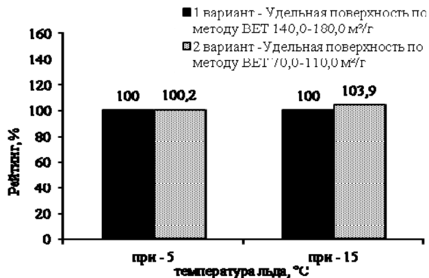
Рис. 2 – Результаты испытаний протекторной резиновой смеси на приборе LAT-100 с применением в рецептуре кремнезёмного наполнителя с удельной поверхностью 70,0-110,0 \text{м}^2/\text{г}
