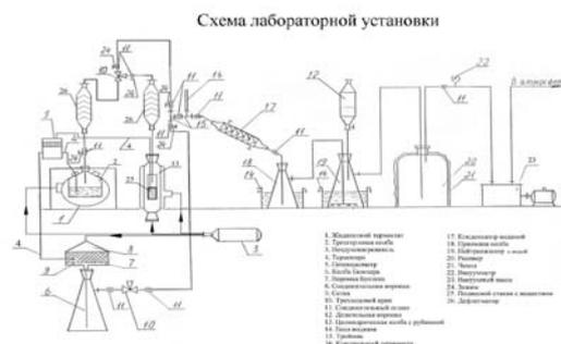
**Рис. 1 – Схема лабораторной термо-вакуум-импульсной установки**
