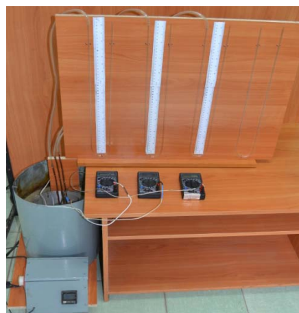
Рис. 1 – Внешний вид экспериментального стенда по определению динамики давления при термомодифицировании древесины
