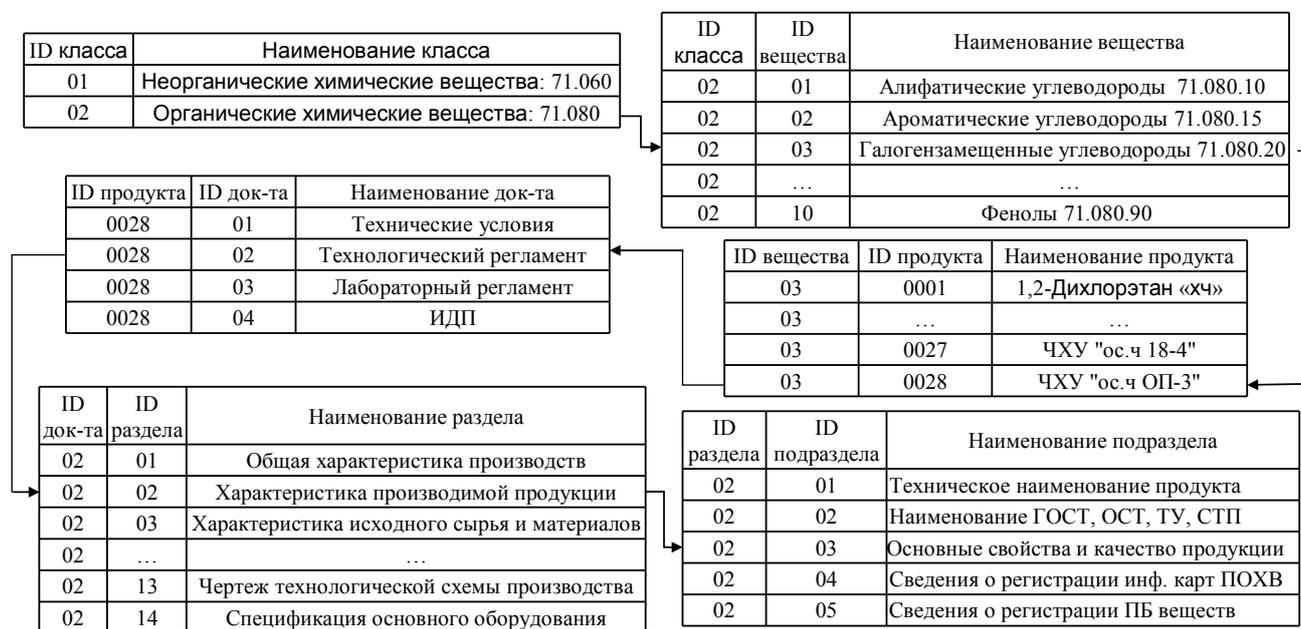
Рис. 3 – Структура базы данных «Технологический регламент»
