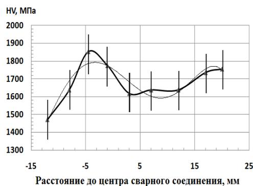
Рис. 3 – Распределение твердости образца с трещиной по сварному соединению (9 измерений)
