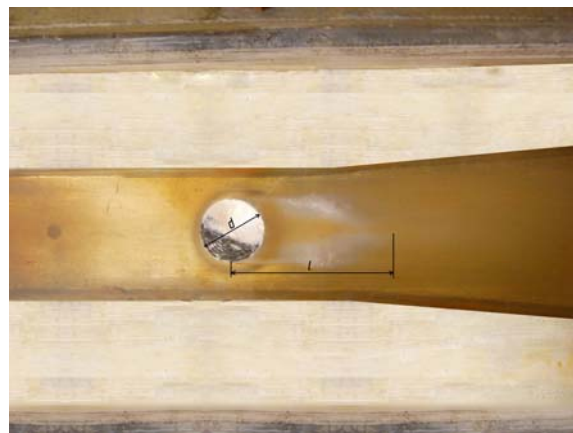
Рис. 2 – Камера кавитационного реактора в рабочем режиме
