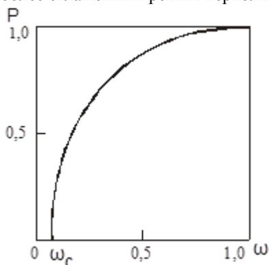
**Рис. 2 – Зависимость вероятности протекания  $P$  от вероятности занятости узла сферой  $\omega$**
