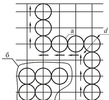
**Рис. 1 – Плоская решеточная модель протекания по касающимся сферам: а – бесконечный кластер; б – изолированный кластер**
