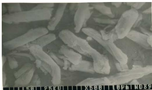
Рис. 4 - Электронно-микроскопический снимок МКЦ-1. Увеличение 500х – кратное
