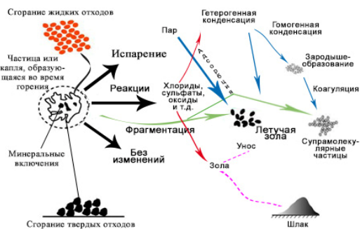
Рис. 1 - Физико-химическая трансформация металла в течение сжигания [28,29,41]
