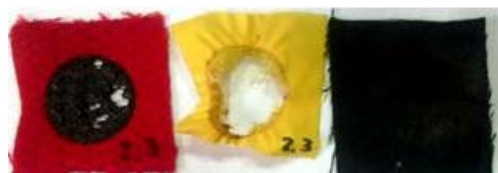
Рис. 1 - Результаты эксперимента при нагреве тепловым потоком 50 \kappa\text{Вт}/\text{м}^2 (материал, обработанный 0,25% раствором алюминиевой пудры)
