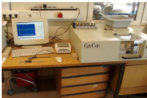
Рис. 1 – Лабораторная установка DA-X для контроля плотности древесины и древесных материалов
