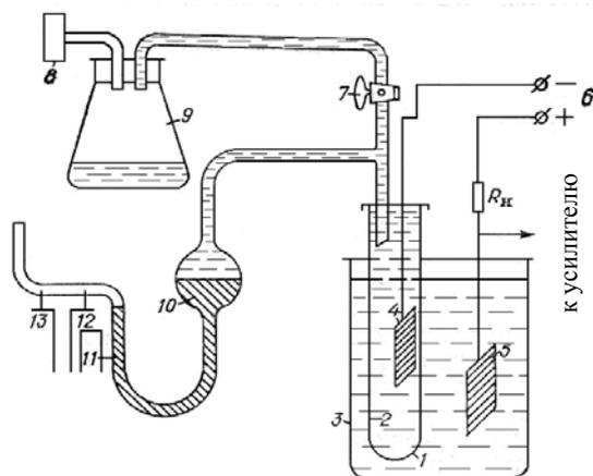
Рис. 1 – Принципиальная схема кондуктометрического счетчика Коултер-Каунтер: 1 – апертура; 2 – микроотверстие; 3 – стакан; 4, 5 – электроды; 6 – источник постоянного напряжения; 7 – кран; 8 – внешний источник разрежения; 9 – разделительный сосуд; 10 – U-образный манометр; 11–13 – контакты
