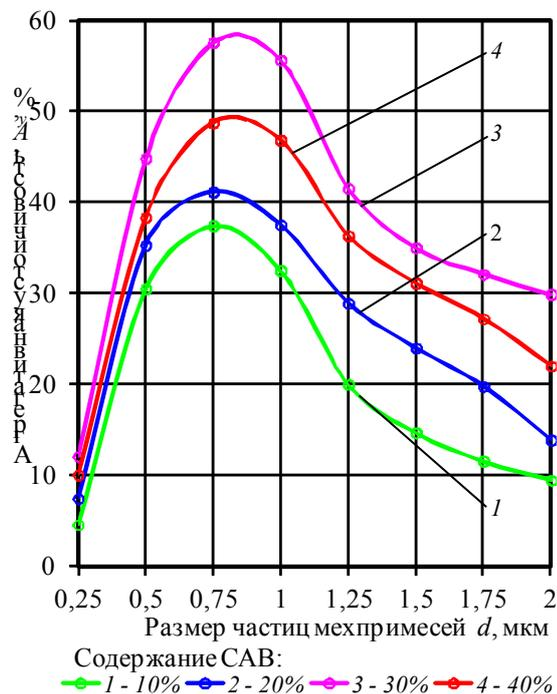
Рис. 4 – Зависимости изменения устойчивости эмульсий от размера частиц мехпримесей
