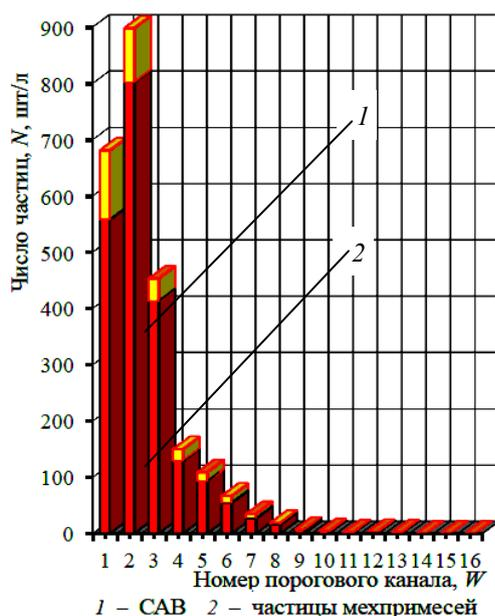
**Рис. 3** – Гистограмма счетного распределения дисперсных частиц по размерам в нефтяной суспензии (исходной нефтяной эмульсии)
