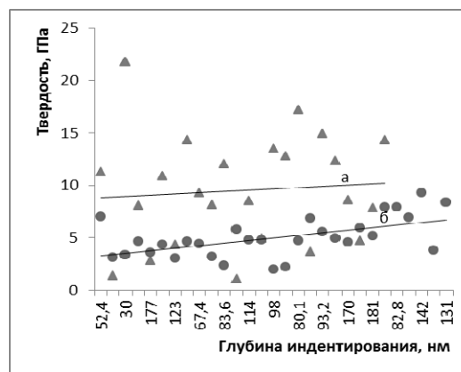
Рис. 4 - Изменение микротвердости поверхности сплава ВК8: а – образец до обработки, б – образец, обработанный по режиму Ar+C_3H_8 , Q_1=1500 \text{ см}^3/\text{мин} , Q_2=1300 \text{ см}^3/\text{мин} , U=-20 \text{ В}
