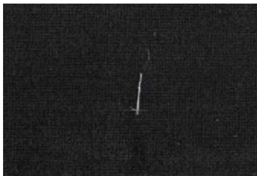
Рис. 1 - Искровой разряд при атмосферном давлении между стальной иглой с диаметром d = 1,5 мм и технической водой при l = 16 мм
