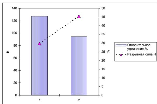
**Рис. 3** – Результаты исследований показателей разрывной силы,  $H$ ; относительного удлинения, %; синтетического нетканого волокнистого материала: 1 – влажный образец; 2 – сухой образец
