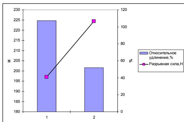
**Рис. 2** – Результаты исследований показателей разрывной силы,  $H$ ; относительного удлинения, %; натурального нетканого волокнистого материала: 1 – влажный образец; 2 – сухой образец
