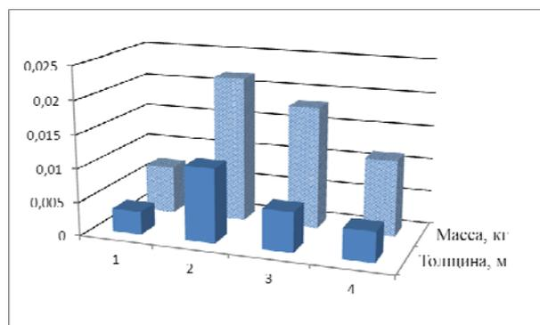
**Рис. 1 – Размерные характеристики образцов войлока: «толщина - масса» (обозначение разновидностей войлока - см. табл. 1)**
