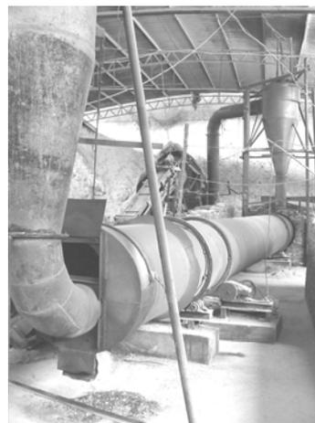
**Рис. 4. Пилотная установка по термомодифицированию древесных частиц – общий вид**
