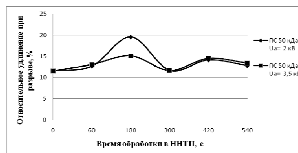
Рис. 3 – Изменение относительного удлинения при разрыве полисульфоновой мембраны 50 кДа
