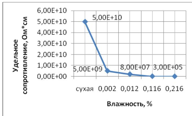
Рис. 2 – Изменение удельного сопротивления аммиачной селитры марки Ч от влажности
