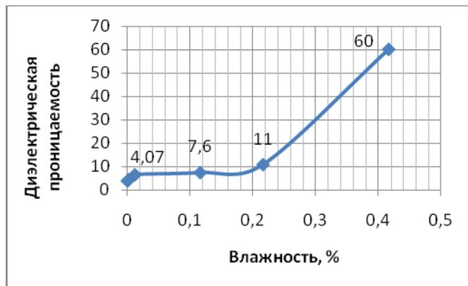
Рис. 1 – Изменение диэлектрической проницаемости аммиачной селитры марки Ч от влажности
