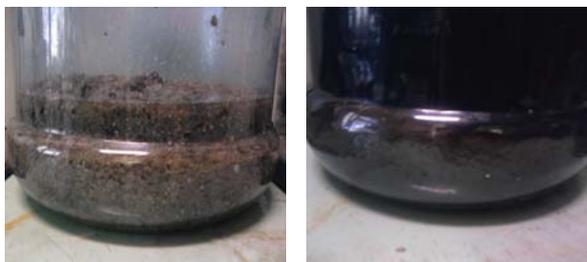
**Рис. 3 – Внешний вид образца до (а) и после (б) щелочной обработки**
