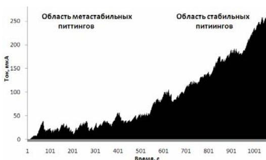
**Рис. 1 - Изменение суммарного значения тока (мкА): частота зарождения  $\lambda=0,05 \text{ см}^{-2}\text{с}^{-1}$ , доля пассивирующихся питтингов  $Q=0,08$ , количество секторов  $N=50$ , время эксперимента  $T=1000$  с, критическое время  $\tau_c=100$  с, индукционное время  $\tau_{ind} \in [0,70]$  с, скорость нарастания тока  $C=0,1 \text{ мкА/с}$**
