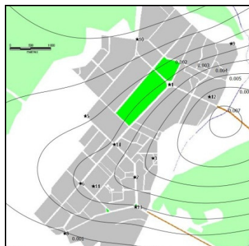
Рис. 2 - Поле концентраций сероводорода, полученное с помощью экспериментальных измерений
