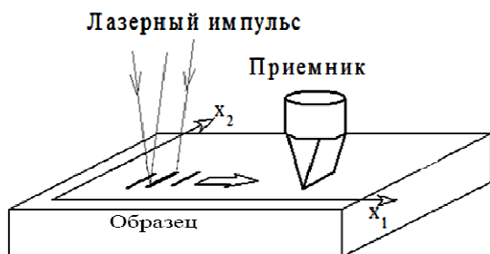
Рис. 2 – Схема дифференциального метода измерений
