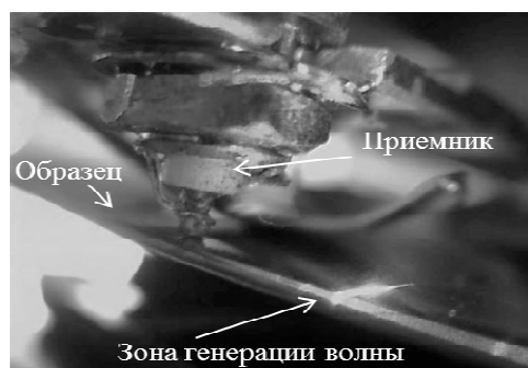
Рис. 3 – Положение приемника и зоны возбуждения волны на лопатке
