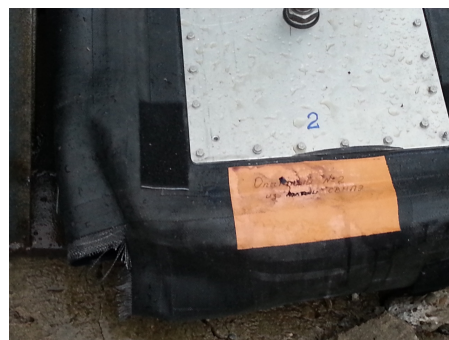
Рис. 5 – Бак на основе ткани СВМПЭ после сброса
