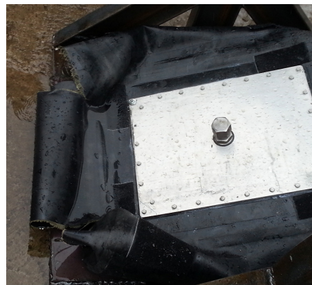
Рис. 4 – Бак на основе ткани Русар после сброса
