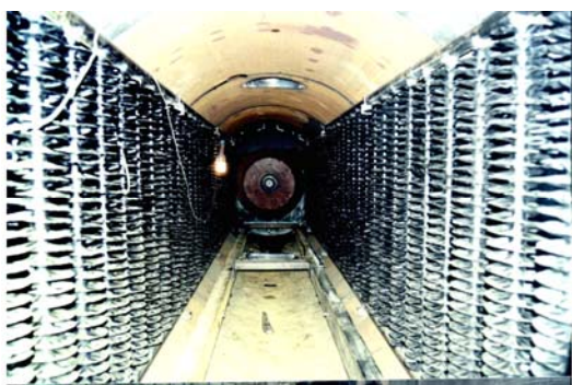
Рис. 3 – Расположение калориферов в сушильном аппарате
