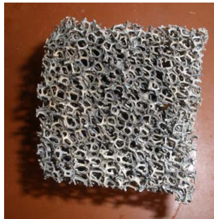
Рис. 4 - Образец пеноникеля, полученный гальваническим способом
