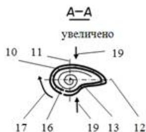
**Рис. 2 – Поперечное сечение выходной и сборной труб змеевика**
