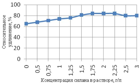
**Рис. 2 - Зависимость относительного удлинения при растяжении кожи из шкур КРС, модифицированных ННТП обработкой и раствором силана, от концентрации силана в растворе**
