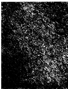
Рис. 4 - Микроструктура (X500) металла вставки штампа для получения поковок вилки карданного вала (альтернативный вариант приготовления расплава)
