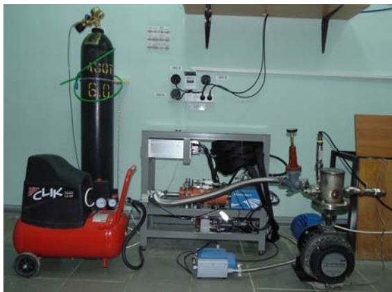
Рис. 1 – Экспериментальный стенд для исследования масс-спектра остаточного газа
